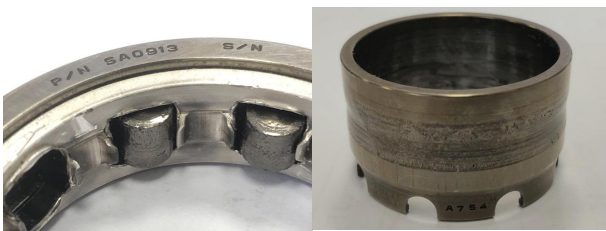
图4 V2500 PT0轴中心轴承损伤细节
